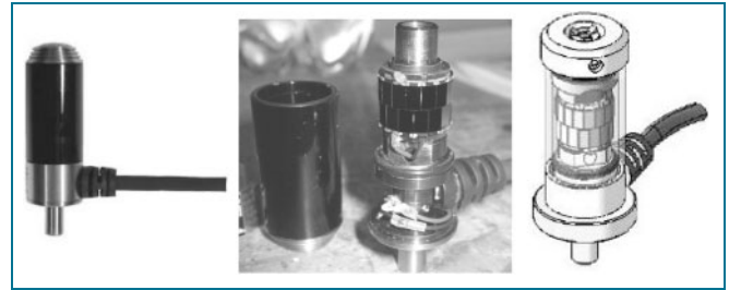
Abb. 5: Zylindrischer Single-Sensor mit Blick ins Innere und schematischem Aufbau
